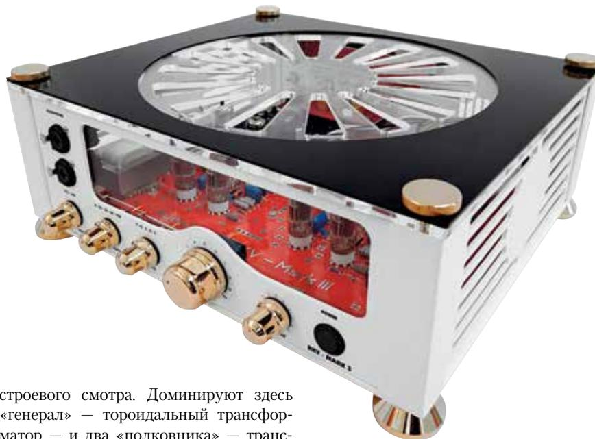
строевого смотра. Доминируют здесь «генерал» — тороидальный трансформатор — и два «полковника» — трансформаторы меньших размеров. Перед правым квартетом ламп (ближе к фасаду) находится вышеупомянутый операционник ОРА134.
