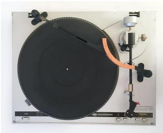
5. Установка рабочего положения шины демфера
