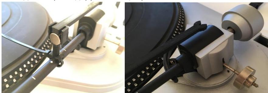
Если вы используете другой измерительный прибор, то выставьте расстояние от оси поворота тонарма до плоскости магнита 72мм.
