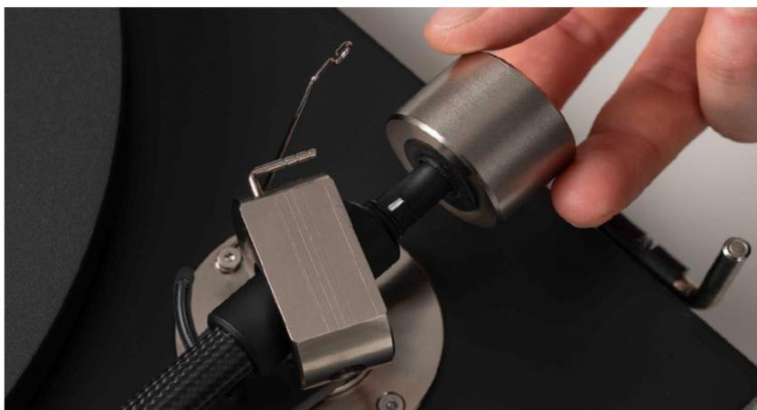
Осторожно проталкивайте противовес (6) на дальний конец опорного элемента противовеса, как показано на фотографии.
