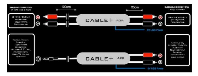
Для подключения кабеля необходимо обесточить коммутируемые компоненты, подключить разъемы, промаркированные **INPUT** к источнику сигнала, а разъемы, промаркированные **OUTPUT**, к усилителю. Только после этого подключить разъем питания мини USB, и включить адаптер питания в сеть.
