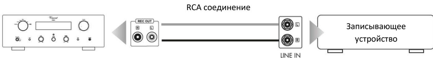
Соедините аудиокабелем входные разъемы (LINE IN, TAPE IN, REC IN) устройства записи (обычно маркированы «Line Out», «Audio Out» или «Front Out») и выход REC OUT (15) усилителя.
