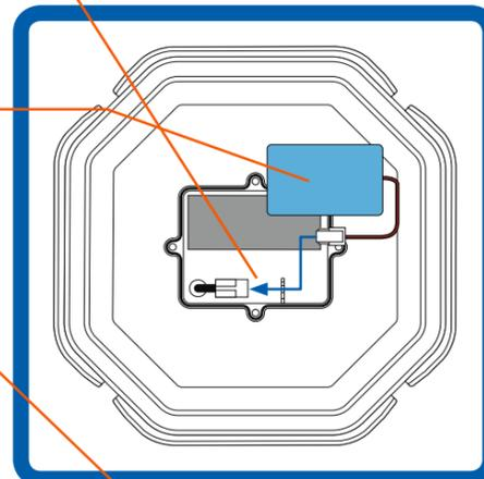
3. Разместите аккумулятор таким образом, чтобы он упирался в пенопластовую прокладку, а провод легко входил в пластиковую канавку
