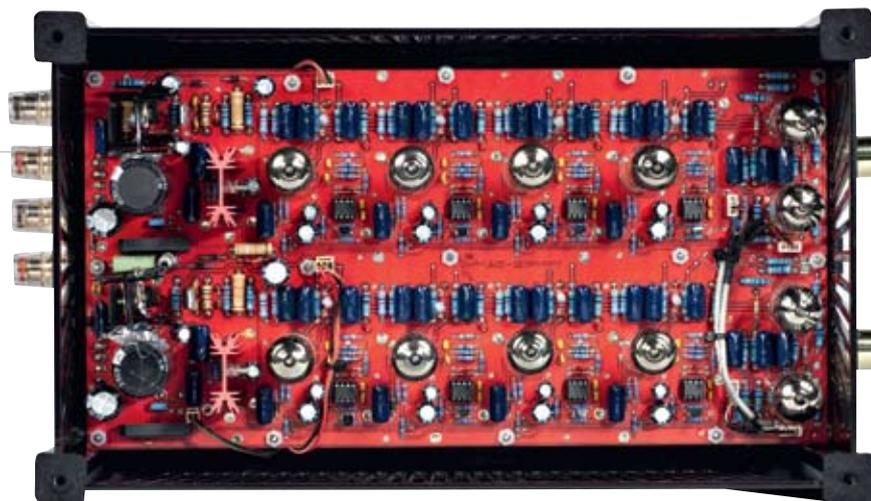
В схеме усилителя выводы анодов, как и управляющих сеток, запараллелены. Накал — с центральным отводом, так что может питаться как 12, так и 6,3 В. Изначально лампа предназначена для ВЧ, работает до 200 МГц.
